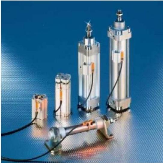
On trouve le plus souvent les capteurs magnétiques comme capteurs de position sur les vérins. Ils se montent directement sur le vérin et détectent la position du piston qui doit être muni d'un aimant.
